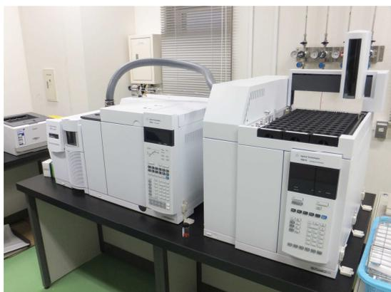
【高速液体クロマトグラフィー質量分析計システム】
