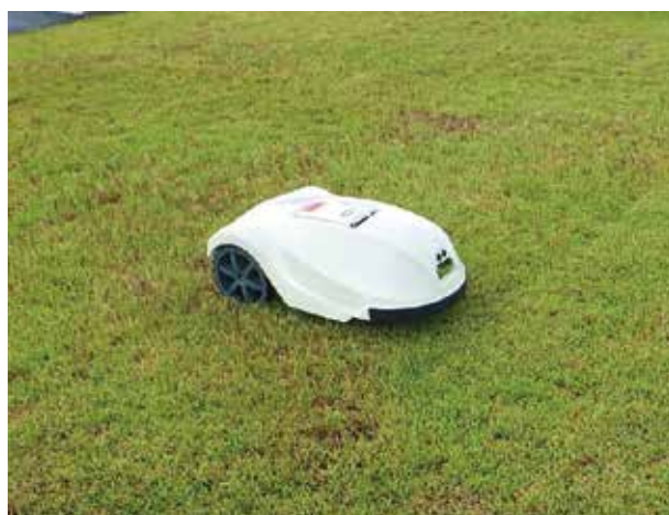
すりかみ浄水場浄水池自動除草装置
