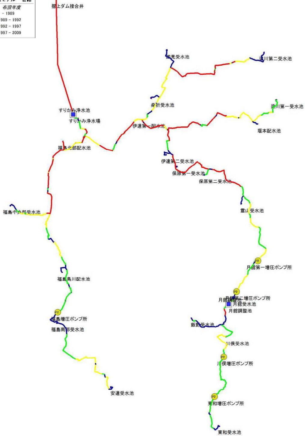
図 3-5 布設年度による管路整備順位の色分け
