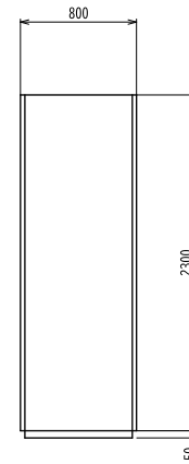
側面図 (引込盤) (補助継電器盤)
